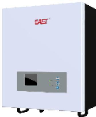
O inversor off-grid onda pura de 3000W da EAST pode abastecer o banco de baterias tanto com a energia dos painéis fotovoltaico quanto com a energia da rede da concessionária. Dispensa o uso de um controlador de carga externo, pois o próprio inversor realiza o controle. Possui duas configurações: armazenamento de energia como prioridade / suprimento de potência como prioridade.
