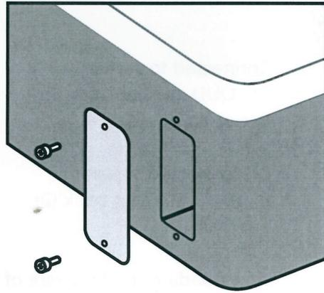
Remova a tampa do encaixe do inversor
