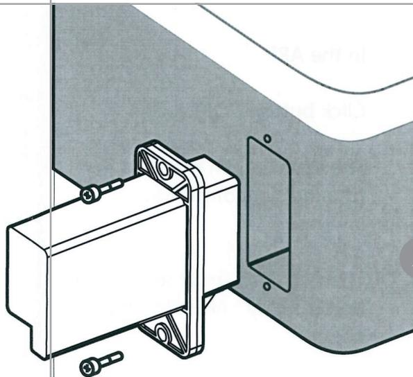
Acople o módulo no encaixe do dispositivo
